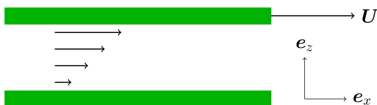
FIG. 5.1 : Expérience idéalisée représentant la viscosité d'un fluide entre deux plaques présentant entre elles un différentiel de vitesse U sur une épaisseur h . La force par unité de surface ( A ) à exercer sur la plaque supérieure en régime stationnaire est \frac{dF}{dA} = \mu U/h .
